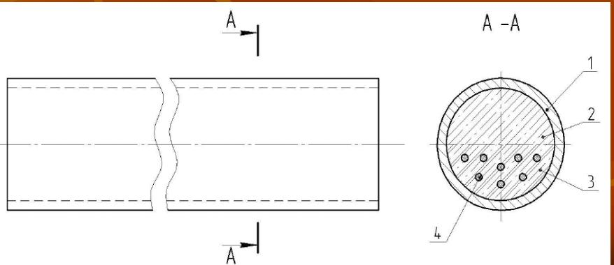
В результате действия предварительных растягивающих усилий в армирующих элементах в сечении трубобетонной балки возникает внецентренное сжатие. Следовательно, предварительно напряженная арматура в трубобетонной балке создает наибольшие сжимающие напряжения в нижней части бетонного ядра, препятствуя в дальнейшем появлению в нем трещин от действия внешних нагрузок.
