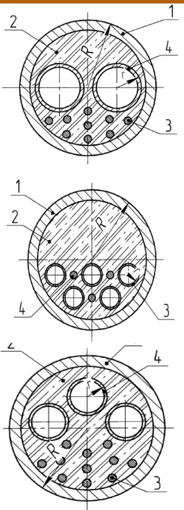
Трубобетонная предварительно напряженная балка состоит из оболочки в виде трубы 1 с бетонным ядром 2, армирующих элементов 3, расположенных в трубе 1 продольно и эксцентрично, и внутренних продольных труб 4. Количество внутренних труб может быть разным.
