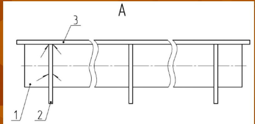
Ортотропная конструкция состоит из продольных элементов, выполненных в виде трубобетонных балок 1, поперечных элементов 2 в виде ребер или фасонных пластин и верхней плиты 3 . Трубобетонные балки 1 жестко закреплены с поперечными ребрами 2 сваркой, а также с верхней плитой 3, сварка которой с балками 1 возможна контактной. Поперечные ребра 2 имеют фасонные вырезы, выполненные по конфигурации продольных трубобетонных балок 1, которые могут иметь круглый или прямоугольный профиль.
