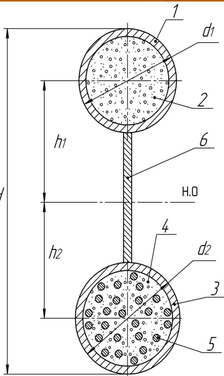
Балка состоит из верхней трубы 1 диаметром  $d_1$  с бетонным ядром 2, нижней трубы 3 диаметром  $d_2$  с преднапряженным бетонным ядром 4 с арматурой (или арматурными тросами) 5. Трубы жестко соединены между собой стенкой 6.
