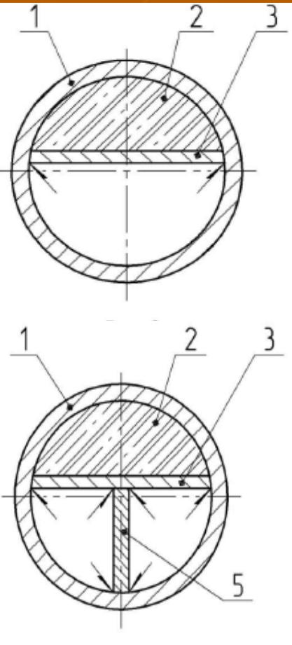
Для увеличения несущей способности балка может содержать в нижней части ребра жесткости 5 в виде пластины, приваренной т-образно к опорной пластине 3 по всей длине балки с опорой на нижнюю часть и сваркой к ее внутренней поверхности
