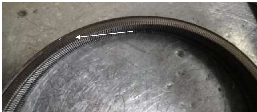
Рисунок 3 – Фото повреждения ремня вариатора
