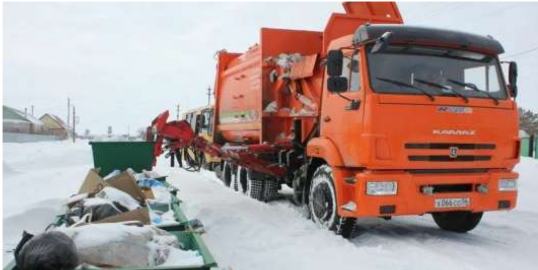
Рисунок 2 – Мусоровоз МК-4555-06 на базе КамАЗ-65111
