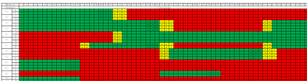
Рисунок 4 – Программа светофорного регулирования на кольцевом пересечении ул. Советской Армии и ул. Антонова-Овсеенко
